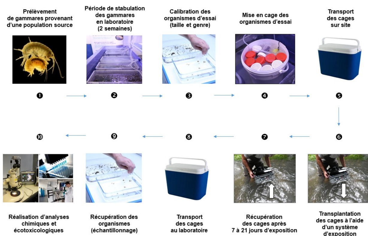
Figure 2 : Les 10 étapes de réalisation des bioessais in situ
